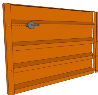
Přinýtování J profilů trhacím nýtem ze zadní strany dílce
